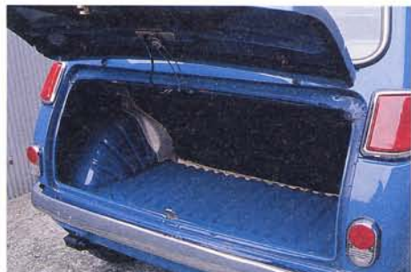
●燃料タンクを床下に、スペアタイヤをエンジンルームに納めたことによって、容量を確保したトランクルーム。後席バックレストは取り外し式のため、長尺物の収納も可能である
