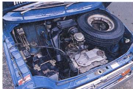
●バイク用をベースに開発された強制空冷並列2気筒OHC 354ccエンジン。CV型キャブを1基装着して、最高出力31ps/8500rpm、最大トルク3.0kgm/5500rpmを発生する
